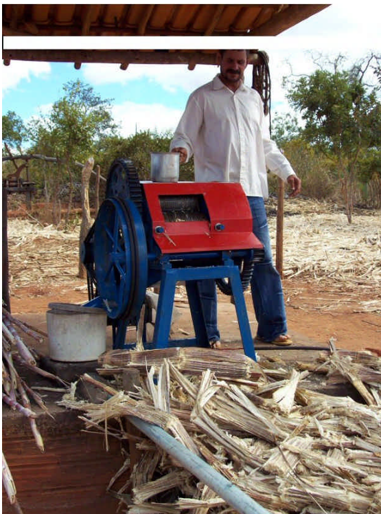
Moinho para o processamento de cana-de-açúcar e rapadura, Assentamento Tapera, Minas Gerais, Brasil (Schumann/Misereor)
